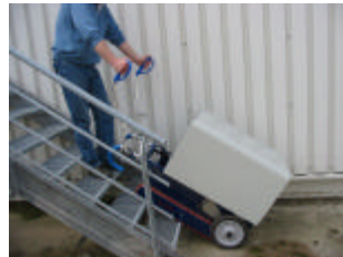
Die Treibriemen liegen immer auf 2 Stufen um einen stabilen Transport zu gewährleisten.
