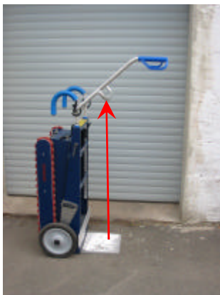
max. Höhe wenn die Handgriffe in der niedrigsten Position sind: 1100 mm.
